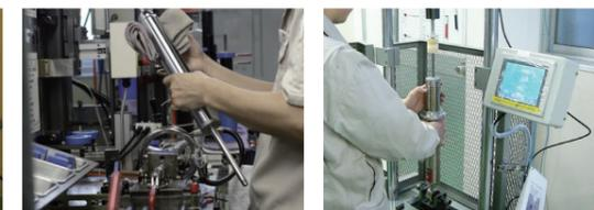
単筒式構造を採用したダンパーと、冷間成形によるスプリングを、社内一貫生産しています。
