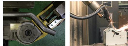
中 / 小規模ロットに合わせた柔軟な製造方法により対応します。
