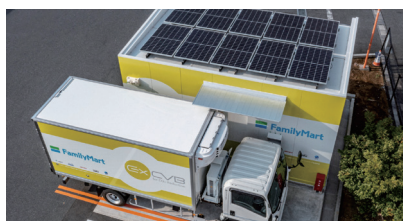
バッテリー交換式小型トラックと太陽光パネル Battery-swapping light duty electric trucks and solar panel
