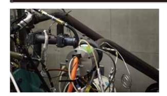
エンジンベンチ試験では1.2Lターボエンジンとの組み合わせで最大8.8kWの発電を確認しました。また実車搭載での発電確認も実施しました。
