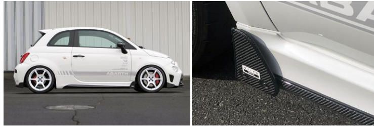
CFRP製サイドスポイラーは、シンプルにまとめたスタイリングで後方への整流効果及びドレスアップ効果を発揮。
