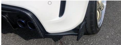
CFRP製リアサイドフィンパネルが装着され後方への整流効果とリアスタイリングの迫力を増すと同時に、車両全体デザインを整えています。
