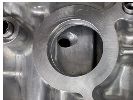
クローズドデッキ化による冷却水の流れの変化を、水穴追加によって最適化
