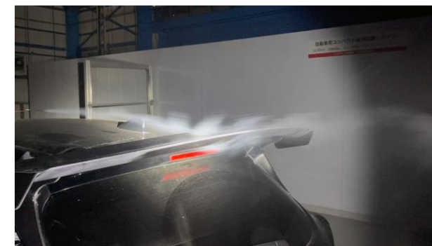
(スモークを流し、通過風が整流されているのを確認)
