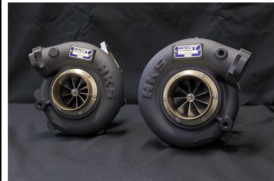
R35専用設計のコンプレッサー。ハウジングをGT5565_BB用に再設計。ポータッドシュラウドを極狭空間で成立。
