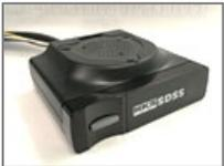
アクセル踏み間違いを防止する機能を中心に、坂道判定など誤作動を防ぐ機能を充実させた車両に後から簡単に取付けができる商品を提供いたします。
