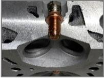
ICE 高効率化技術として、ラジアル（放射状）バルブレイアウト技術（燃焼室形状の最適化による高効率化）、プレチャンバー技術（急速燃焼による高効率化）等をご紹介します。
